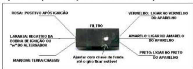
**NOTA:** Pode ser usado para Diesel no caso de precisar adequar o sinal para o conta-giros. Filtrar e ajustar o nível de sinal para a entrada do conta-giros do instrumento.
