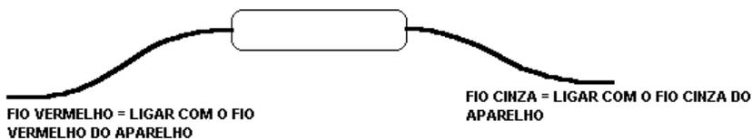
No final da instalação do sensor, imobilize os cabos desde a saída do sensor até o instrumento evitando movimentação/vibração e rompimento do cabo. Não forçar dobras dos cabos com raio de dobra muito pequeno e aplique abraçadeiras não muito apertadas, evite romper ou provocar curto circuito nos fios internos podendo danificar o sensor ou até mesmo o instrumento.
