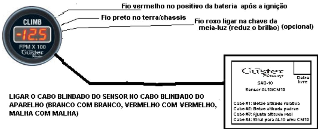
Ao ligar o aparelho acende por 1 segundo todos os displays e inicia a leitura do sensor SAC-10 para processar a subida ou a descida.
