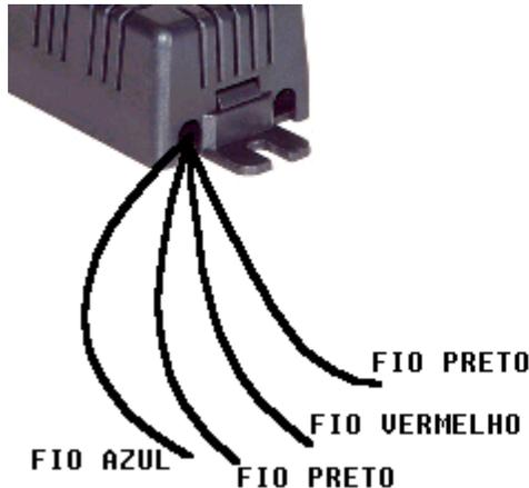
LIGAÇÃO DOS FIOS**FIO AZUL=ENTRADA DE 24VCC (positivo)****FIO PRETO=GND ENTRADA (NEGATIVO)****FIO VERMELHO=SAÍDA DE 15VCC (positivo)****FIO PRETO=GND SAÍDA (NEGATIVO)****Obs:Os 2 fios pretos
