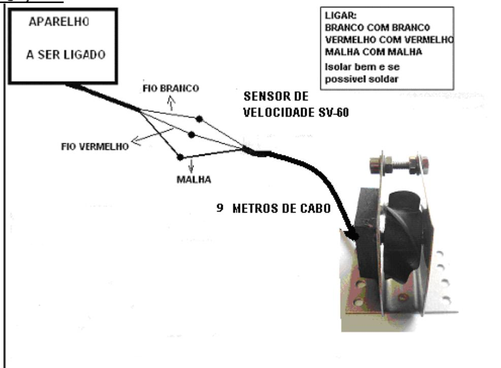
Dimensões: 50x45x47 mm, ficando cerca de 1 cm abaixo do nível do casco do barco.
