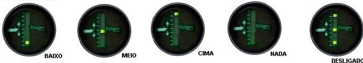
Ao se ligar o fio cinza com o preto (com o aparelho ligado) passa a mostrar as figuras acima em intervalos de 2 segundos. Quando se solta o fio cinza a figura mostrada nesse momento indica se estamos gravando posição do TRIM (BAIXO, MEIO, CIMA ou NADA). Isto é apenas válido até 20 segundos após ligar o aparelho.
